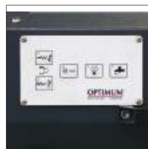
Pannello a membrana integrato per il massimo controllo Attivazione disattivazione avanzamenti Gestione movimento rapido assi X e Z Comando per luce, impianto refrigerante
