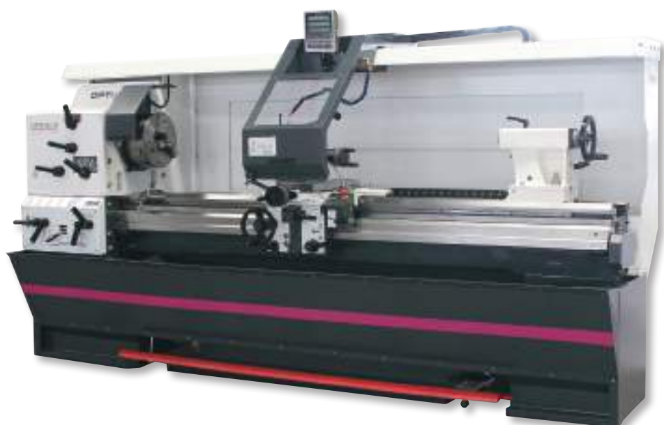
Pannello a membrana integrato per il massimo controllo Attivazione disattivazione avanzamenti Gestione movimento rapido assi X e Z Comando per luce, impianto refrigerante
