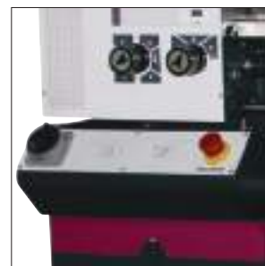
Pulsanti a membrana Interruttore principale lucchettabile Pulsante di avvio Selezione del senso di rotazione Due pulsanti di emergenza
