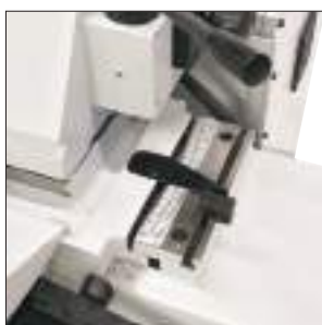
Per la rettifica conica tra i centri, la tavola può essere ruotata da +3° a -9°
