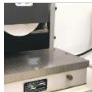
Piano magnetico magneti permanenti Sistema veloce e sicuro per bloccare il pezzo
