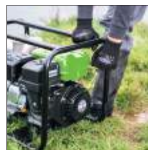
Motore a 4 tempi con avviamento manuale
