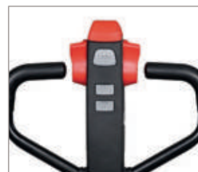
Comodo controllo di velocità, direzione di marcia e frenata tramite interruttori a bilanciere di facile utilizzo. Pulsanti grandi e facilmente accessibili per alzare e abbassare forcella, clacson
