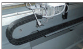
· Disposizione dei collegamenti tramite catena
