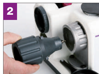
2 Affilature taglienti · Tramite piccole rotazioni da arresto ad arresto
