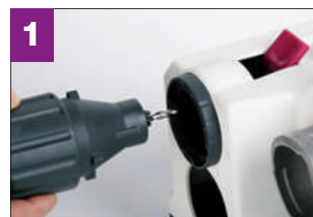
1 Inserimento punta · La punta elicoidale viene allineata in base alla lunghezza di sporgenza e all'angolo appropriato
