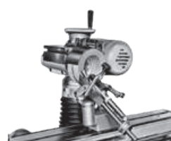
Affilatura di una punta elicoidale Grinding a twist drill
